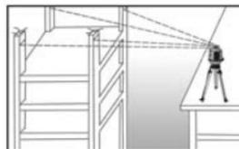
Repère pour l'installation d'un plancher de ciment
